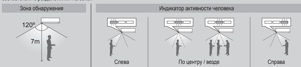
Для обновления индикации аппарата требуется несколько секунд, чтобы определить зону человеческой активности. На основе зоны человеческой активности жалюзи горизонтального направления потока воздуха будут отрегулированы или зафиксированы в заранее заданной позиции, или будут периодически двигаться влево/вправо.
