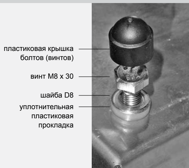
Рисунок 4 –соединение вентилятора с удлинителем
