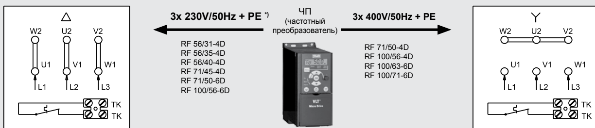
Рисунок 7 – включение в звезду/треугольник (Y/Δ) 3-хфазного электромотора мотора с частотным преобразователем, защита IP21 (RFFMIMxxxx20)
