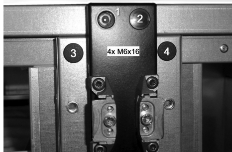
Рисунок 16 - Демонтаж междверной стойки
