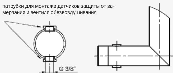
Рис. 17 – монтажа датчиков защиты от замерзания
