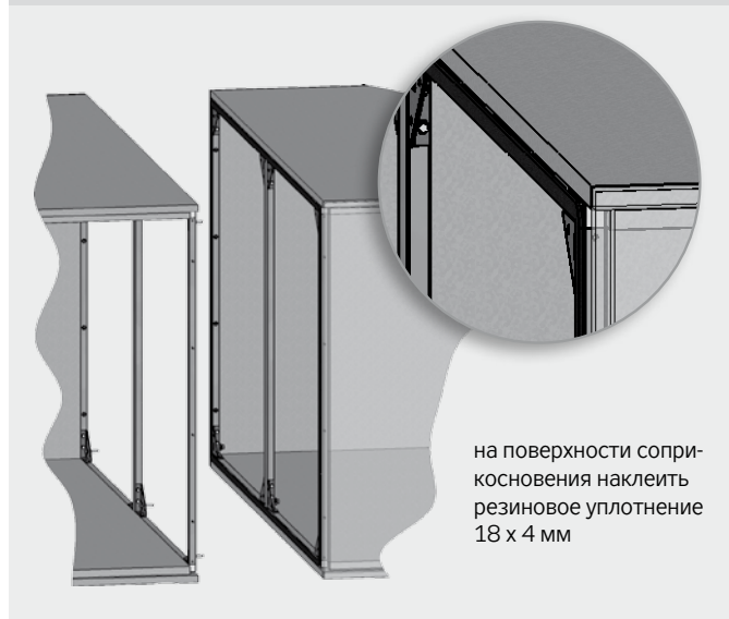
Рис. 7 – уплотнение между секциями
