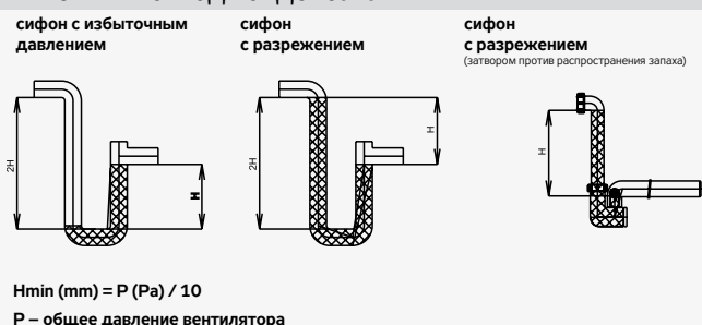
Рис. 21 – отвод конденсата
