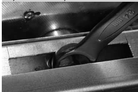
Рисунок 8 – Осевой болт отпустить ключом №24
