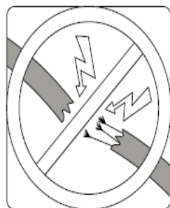
Перевірити цілісність кабелів
