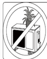
Пересвідчитись, що притік і витік повітря не заблоковані
