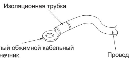
Подсоединяйте провода одинакового диаметра с обеих сторон.
