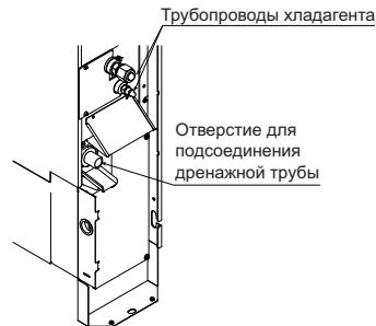
Подсоедините дренажную трубу после удаления резиновой пробки и изолационной трубки, прикрепленной к соединительному отверстию.
