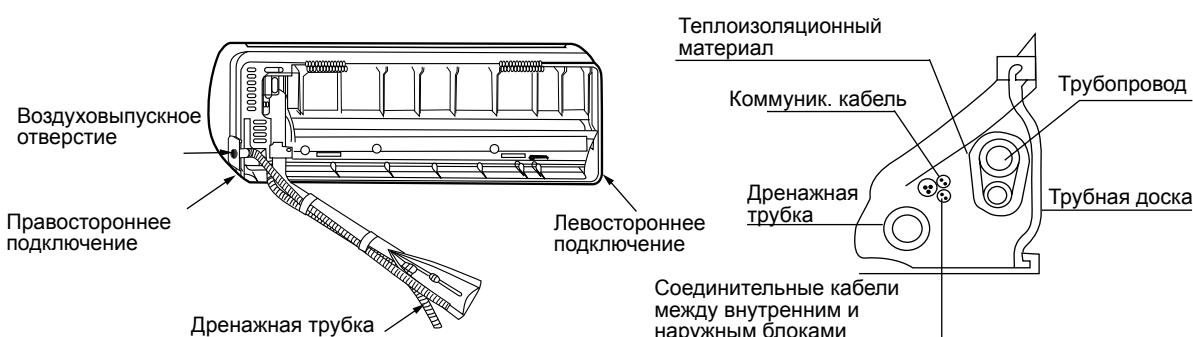
(4) Подведите трубопровод (линия жидкости и линия газа) к стенному отверстию. Стяните вместе трубопровод хладагента, дренажную трубку и соединительные кабели. Протяните трубный и кабельный пучок через стену наружу, чтобы далее выполнить подсоединение к наружному блоку. Удостоверьтесь, что при подключении соединительного кабеля к внутреннему и наружному блоку соблюдено соответствие нумерации контактов и цветовой маркировки проводов для обоих блоков.
