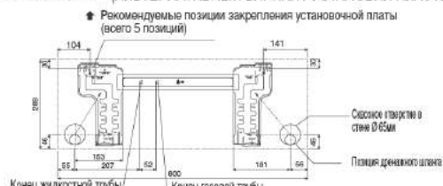
FTYN 20/25/35 (АЛЬТЕРНАТИВНЫЙ ВАРИАНТ УСТАНОВКИ ПЛАСТИНЫ)
