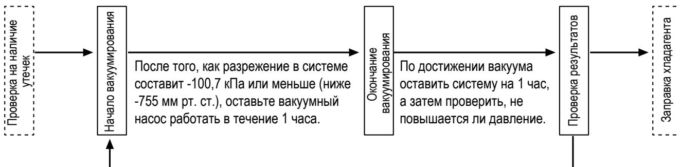
Если после вакуумирования давление в системе повышается, это свидетельству-ет о наличии влаги в системе или утечках. Проведите проверку системы, устранитите утечки и удалите влагу, а затем опять выполните вакуумирование.
