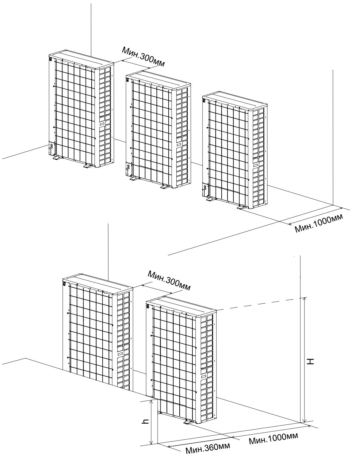
Если высота ограждающей конструкции  $h$  превышает установочную высоту блока  $H$  ( $H$  = высота блока + высота опорного основания), его необходимо установить на дополнительное основание, так чтобы  $H \geq h$ .
