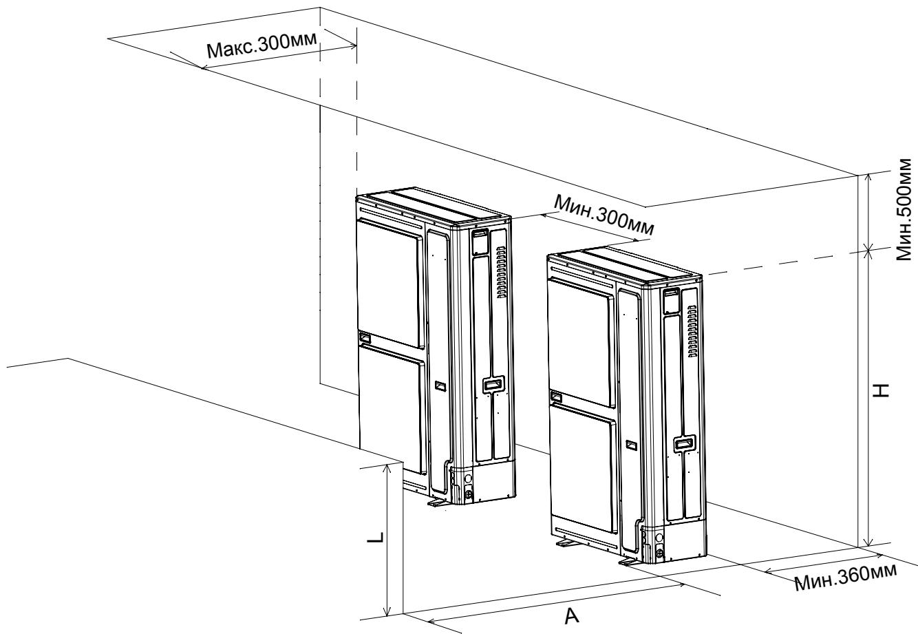
**Вариант 3: ограждающие конструкции расположены на стороне выхода воздуха, а также слева и справа от блока**
