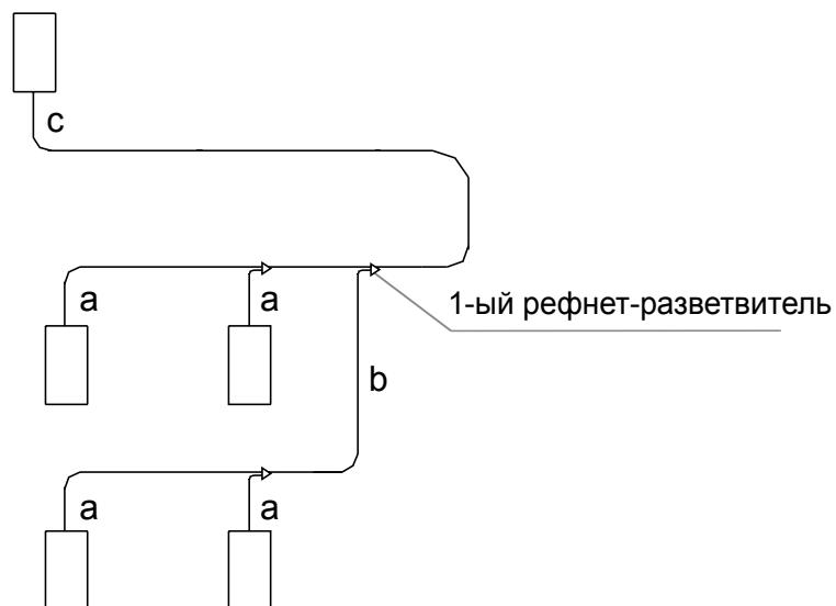
1. Диаметр трубопровода «а» между внутренним блоком и разветвителем определяется типоразмером внутреннего блока.
