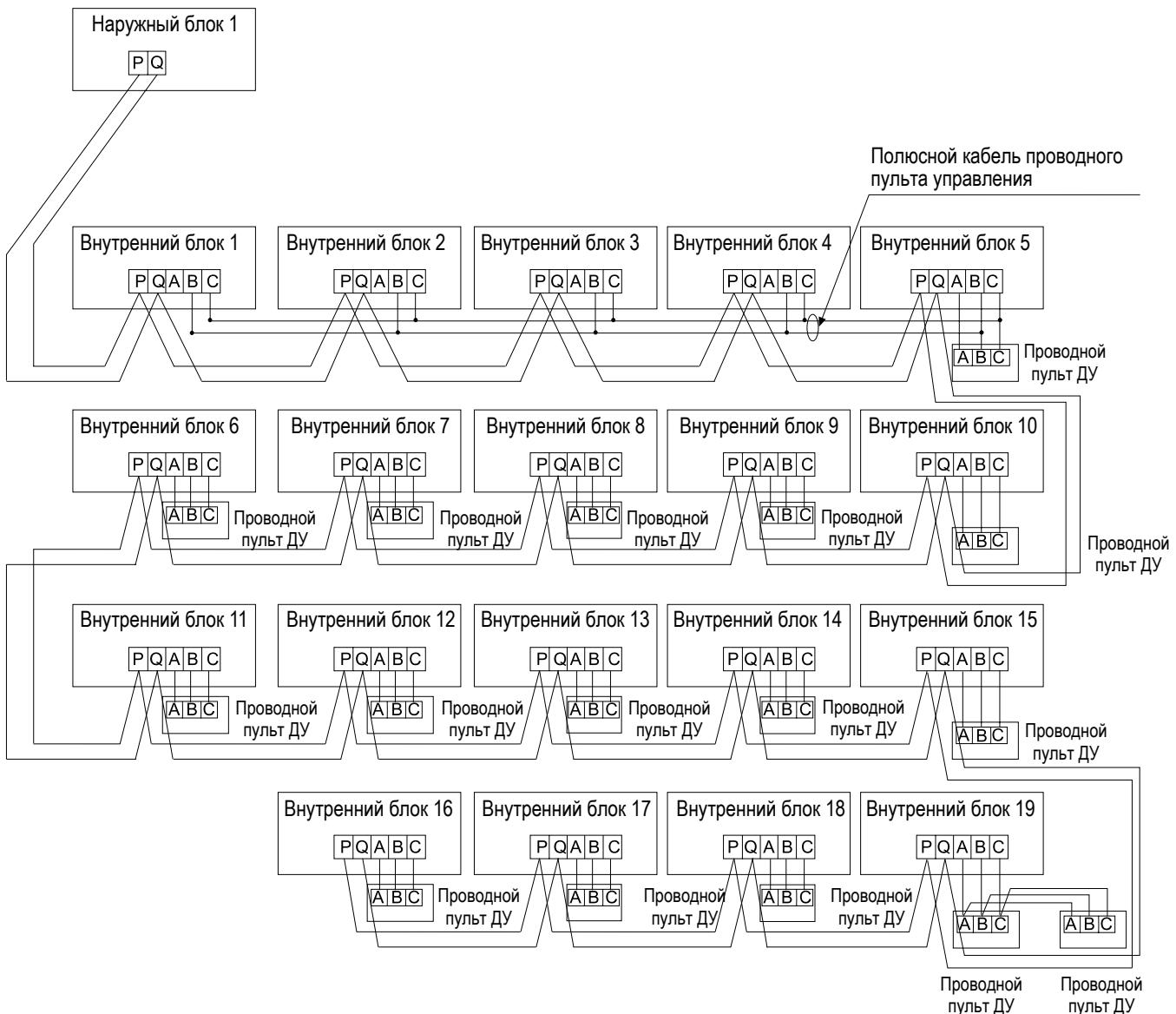
Соединение наружного блока с внутренним, а также всех внутренних блоков между собой выполняется параллельно, посредством 2-х жильного экранированного кабеля (типа МКЭШ 2х0,75-2).
