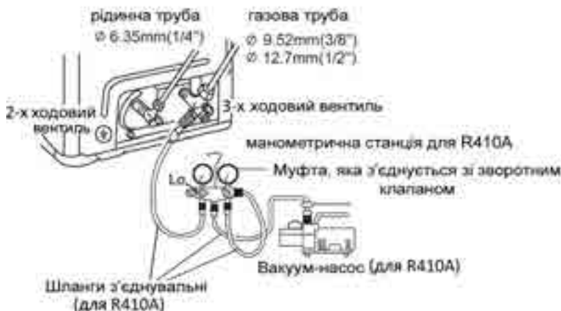
Схема присіднання вакуум-насосу до зовнішнього блоку
