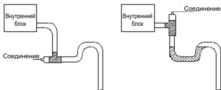
№1: 3-ходовое соединение дренажной трубки
