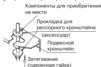
[Закрепление рессорного кронштейна]
