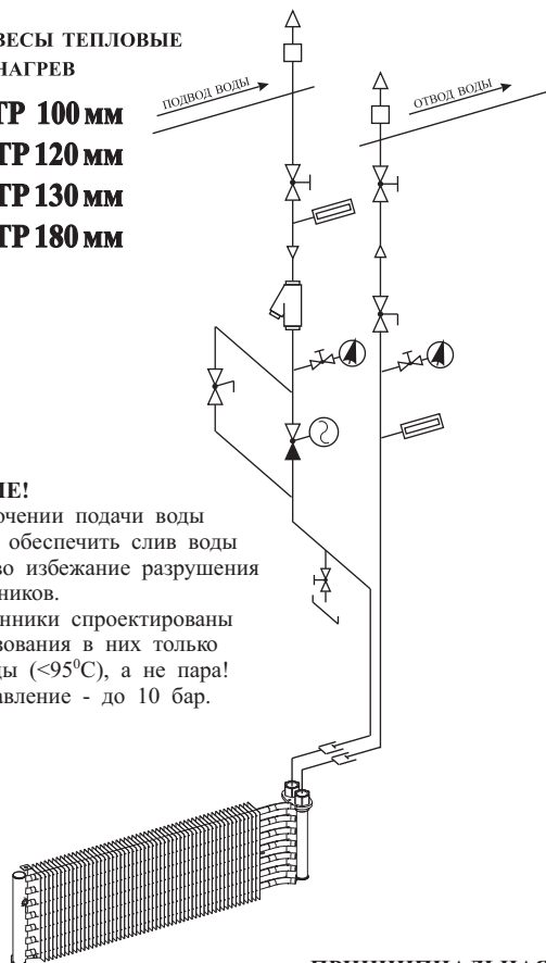
ПРИНЦИПИАЛЬНАЯ ГИДРАВЛИЧЕСКАЯ СХЕМА ДЛЯ МОДЕЛЕЙ С БОКОВЫМ РАСПОЛОЖЕНИЕМ ДВИГАТЕЛЯ (L или R)
