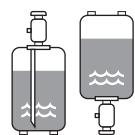
Заправка жидкого хладагента с помощью цилиндра в перевёрнутом положении.
