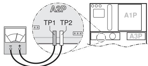
3 Во избежание повреждения печатной платы прикасайтесь к неокрашенной металлической детали для снятия статического электричества, прежде чем снимать и одевать разъёмы.
