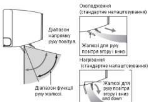
Рух повітря з допомогою жалюзі у вертикальному напрямку
