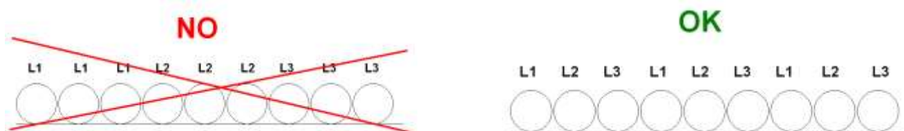
Рис. 17 - прокладка проводов питания большой длины
