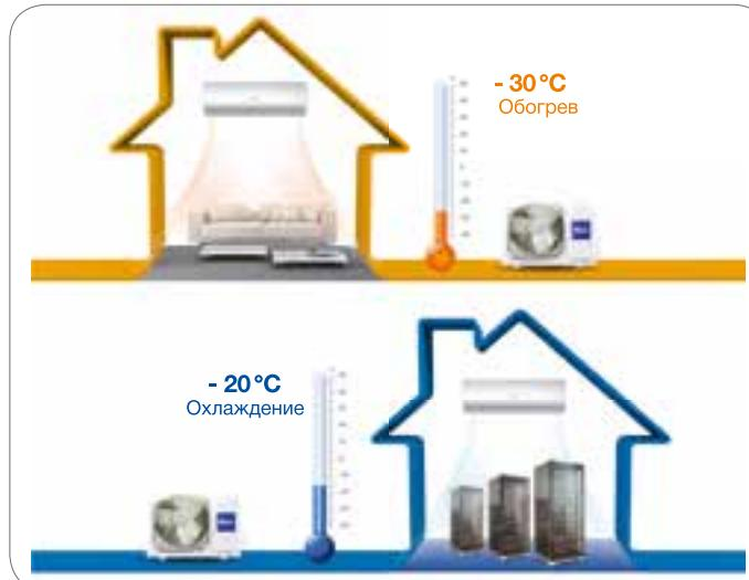
Возможность работы кондиционера в широком диапазоне наружных температур обеспечивается за счет усовершенствования конструкции спаренного ротационного компрессора, высокоеффективного DC-электродвигателя, оптимизированной конструкции основания наружного блока, дополнительного электронагревателя компрессора, специальной программы функции оттаивания и других конструктивных преимуществ.
