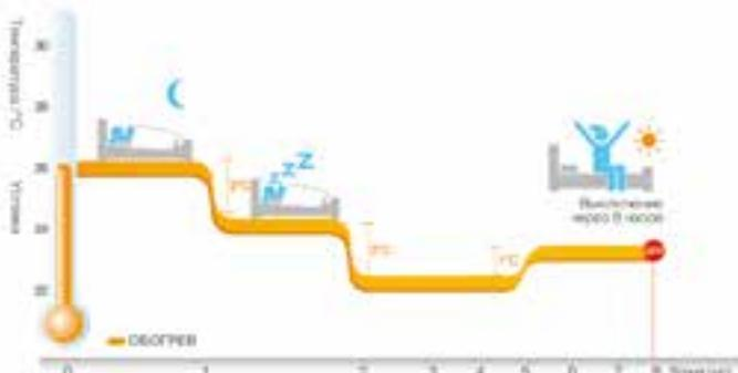
В режиме обогрева температурная уставка снижается на 2 °C в течение 1-го часа, затем еще на 2 °C в течение последующего часа. Такая температура поддерживается 3 часа, затем повышается на 1 °C, и через 3 часа кондиционер выключается.
